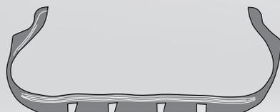
Section du pneu et simulation de profil
